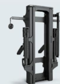
**Opzionale – Montante duplex con sollevamento libero:** cilindro di sollevamento nel montante duplex con sollevamento libero posizionato a lato del montante, con conseguente vista completa attraverso lo spazio libero centrale del montante.
