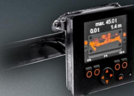
I tre display sono disposti in modo perfetto per una rapida comprensione: il display principale con tutti i dati sulla macchina e il rendimento è integrato nella console. L'head-up display con le informazioni sulla spreader si trova sul bordo anteriore del vetro del tetto e, quindi, al posizionamento dello spreader si trova nelle direzioni dello sguardo del conducente, mentre il display della telecamera posteriore si trova sul lato sinistro della console.
